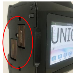
2インチは、1インチカートリッジを2個使います（連結部は印字がずれやすいのでご注意ください）
