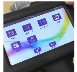
タッチパネルでレイアウトを編集し、文字、QR、バーコード、画像、時間、ナンバリングなど印字できます
